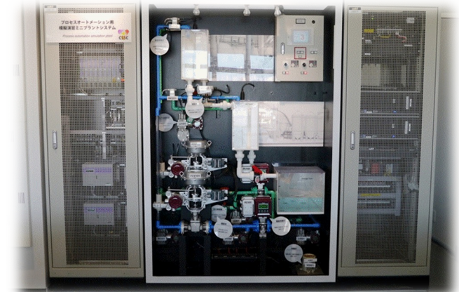
水位一定制御プラント
