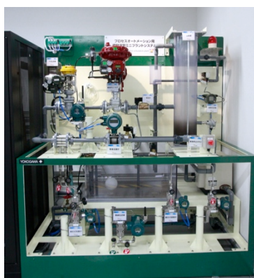
▲模擬プラント例（PA：プロセスオートメーション）
